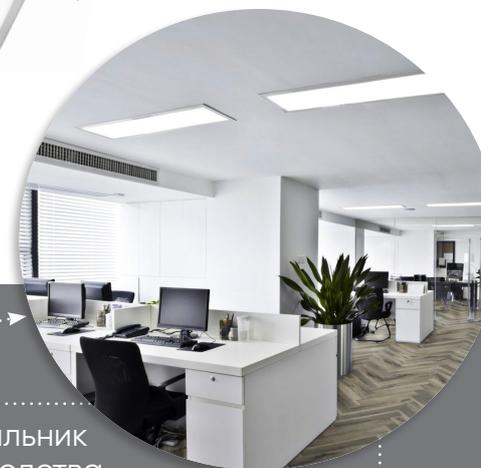
Светодиодный светильник российского производства Feron серии TR Маркет используются для основного освещения коммерческих помещений, офисов, магазинов и тп. Драйвер расположен вне зоны видимости. Рассеиватель из полистирола не желтеет и не изменяет формы в процессе эксплуатации, создает наиболее комфортный для зрения световой поток, а отсутствие пульсаций освещенности обеспечивает полную безопасность для зрения.
